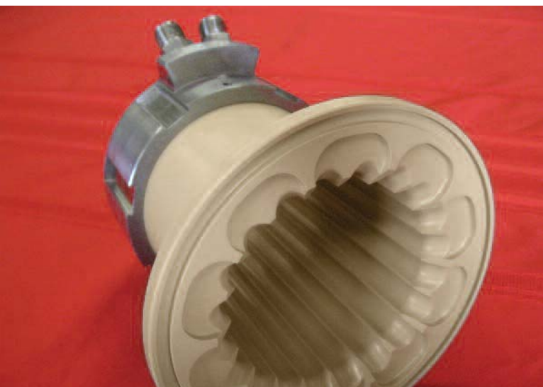
빅트렉스® PEEK 폴리머는 치수 안정성, 낮은 무선 주파수(RF) 손실 및 새로운 1-파트 설계를 가능하게 한 가공성으로 인해 콜링 재킷에 활용되었습니다.
