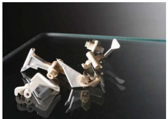
빅트렉스® PEEK 폴리머는 마찰환경에서도 우수한 내열성을 제공하며 별도의 2차 가공을 없애고 프린터 스플릿 핑거의 불소수지 코팅이 된 금속을 대체할 수 있습니다.
