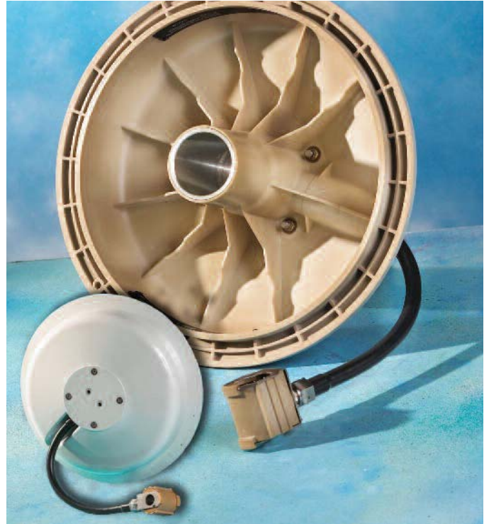
비행기 착륙기어 허브 캡에 적용되는 VICTREX® PEEK 폴리머는 공중파편의 충격을 견딜 수 있으며 약조건에서도 우수한 내환경성을 보입니다.
