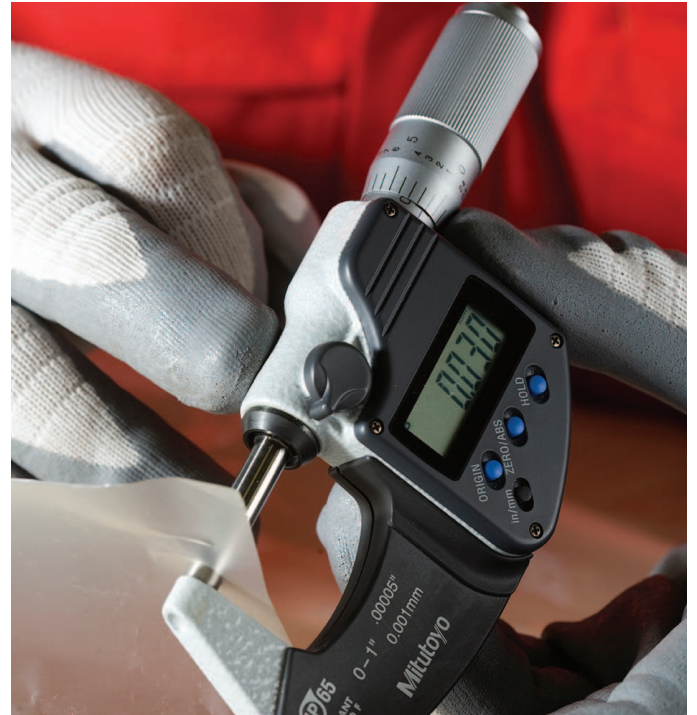
Dickenmessung einer extrudierten APTIV® PEEK Folie.
